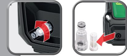
Adapter entfernen, Filter herausziehen
