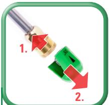
Bei Bedarf: Düse wechseln
