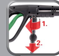
Hochdruckschlauch von Pistole entfernen
